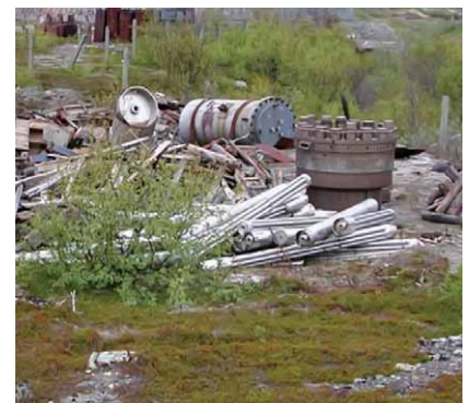
Площадка № 3. Твердые (металлические) радиоактивные отходы. На снимке видно радиоактивное оборудование, которое было демонтировано из реакторных отсеков при перезарядках ядерных реакторов, замене парогенераторов, замене шихты первого и второго контуров, а также при выполнении других операций. На переднем плане видны чехлы из-под ОТВС. Слева – металлические бочки, в которые загружался радиоактивный мусор. На грунт 3-й площадки были слиты десятки тысяч литров радиоактивной воды. Окружающая территория загрязнялась стоками и радиоактивной пылью, которую разносил ветер
