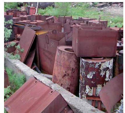
Площадка № 3. Твердые (металлические) радиоактивные отходы. Металлические контейнеры для радиоактивного мусора
